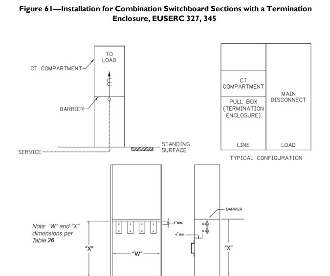
PULL BOX (TERMINATION ENCLOSURE) DETAIL
